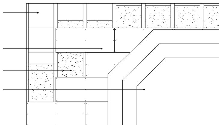
Il sistema è poi corredato da materiali ad elevato sfasamento termico come la nostra fibra di legno **Fibertherm®** poste nell'interasse.
